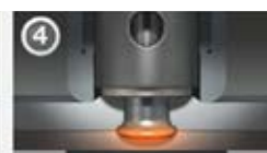
4 Komprimering/bildning av den svetsade fogen
