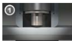
1 Penetration av täckplåten
