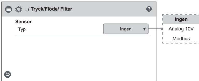
Service 1991 – Installation / Kringutrustning / Tryck/Flöde / Filter
