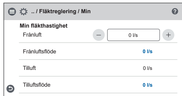
Wizard – 12.3 – Fläktaglering "CAV"/ Min fläkthastighet
