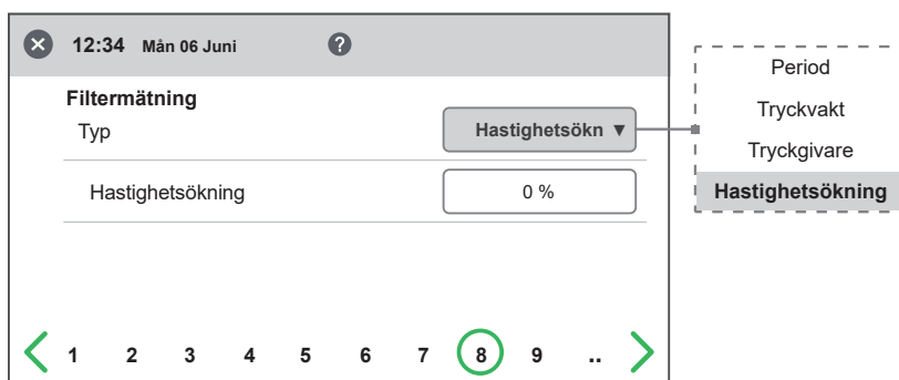
Wizard – 8 – Filtermätning – Hastighetsökning
