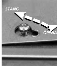
Fläkten är enkel att öppna för rengöring och service med swing-out utförandet. Lossa skruvarna några varv, utan att ta ur dem. Vrid motorplattan åt höger så att skruvarna går igenom den större delen av nyckelhålen. Öppna motorplattan. Vid stängning, vrid motorplattan åt vänster så att skruvarna går i den mindre delen av nyckelhålen. Skruva åt.
