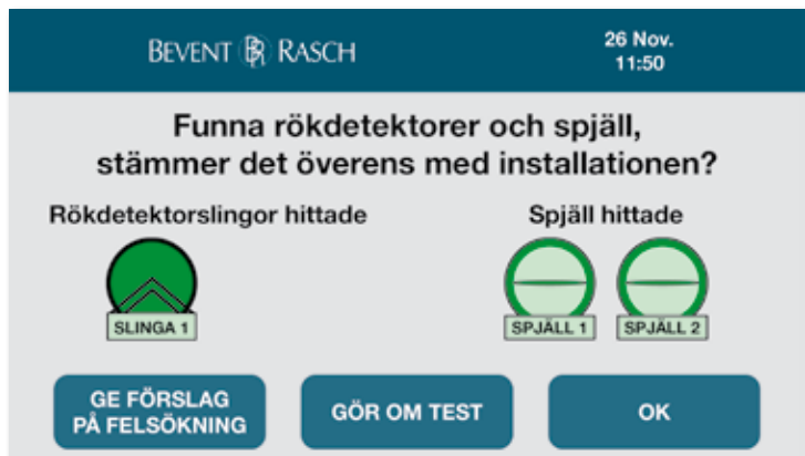
Exempelsystem med 1 st rökdetektorslinga och 2 st brandspjäll.
