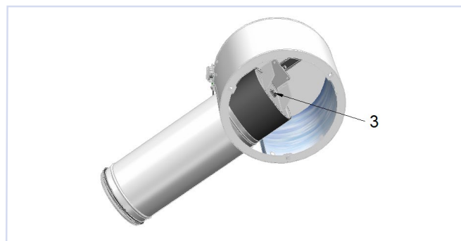
Bild 10, Avlägsna vingmuttern (6 mm) från spjället (3) och dra spjället till den bakre positionen. Ställdonet och spjället har nu lossats från sargen. (MI)
