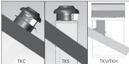
*Fläkten ska monteras på ett sådant sätt att service och underhåll kan utföras. Tänk på lufttirkningen vid monteringen. Ha fläkterns vikt i beaktande vid montering och inklädning.*
