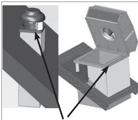
*TKS och TKV/TKH monterad på takgenomföring TFU. Ha i beaktande hur fläkten ska öppnas vid rengöring. Se till att ramen är tät mot genomföringen, så att vatten ej kan tränga in.*
