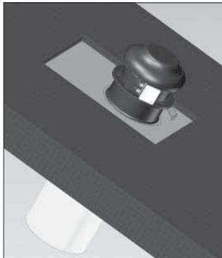
*TKC monterad på takgenomföring TGÖ. Ha i beaktande hur fläkten ska öppnas vid rengöring. Se till att ramen är tät mot genomföringen, så att vatten ej kan tränga in.*
