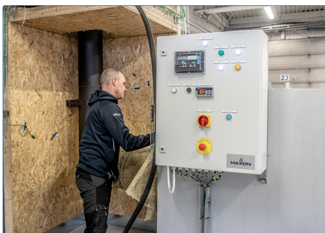
Brännugn redo för provledning av skorsten.
