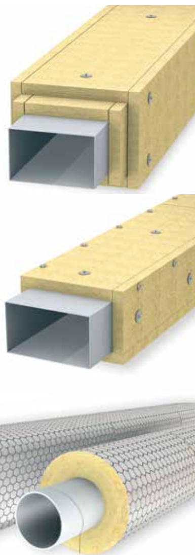
Brandisolering av ventilationskanaler isolerade med PAROC brandskivor för rektangulära kanaler och med PAROC nätmattor för både cirkulära och rektangulära kanaler.
