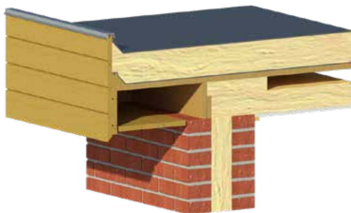
Fig. 18: Stängning av ventilationsöppningar vid tilläggsisolering.
